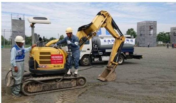
【重機への給油作業の様子】
